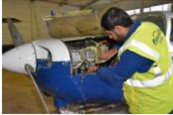
**Tätigkeits-/Situationsbeschreibung:** Überholen von Fluggeräten; zerlegen bei der Wartung einzelne Systemkomponenten und setzen sie wieder zusammen
